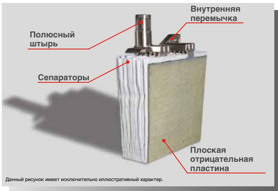
В АККУМУЛЯТОРАХ FIAMM СЕРИИ SLA ПРИМЕНЯЕТСЯ ТЕХНОЛОГИЯ AGM (ABSORBED GLASS MAT – ПОРИСТЫЙ ЗАПОЛНИТЕЛЬ ИЗ СТЕКЛОВОЛОКНА). ЭЛЕКТРОЛИТ ПОЛНОСТЬЮ ВПИТЫВАЕТСЯ В СТЕКЛОВОЛОКОННЫЙ СЕПАРАТОР, ЭФФЕКТИВНОСТЬ РЕКОМБИНАЦИИ ГАЗОВ СОСТАВЛЯЕТ 99%. БЛОКИ ОТЛИЧАЮТСЯ ПРОЧНОСТЬЮ, ГЕРМЕТИЧНОСТЬЮ И НЕ ТРЕБУЮТ ДОЛИВКИ ЭЛЕКТРОЛИТА В ТЕЧЕНИЕ ВСЕГО СРОКА СЛУЖБЫ. НИЗКИЙ УРОВЕНЬ САМОРАЗРЯДА ПОЗВОЛЯЕТ ХРАНИТЬ БАТАРЕИ БЕЗ ЗАРЯДКИ ДО 6 МЕСЯЦЕВ.
