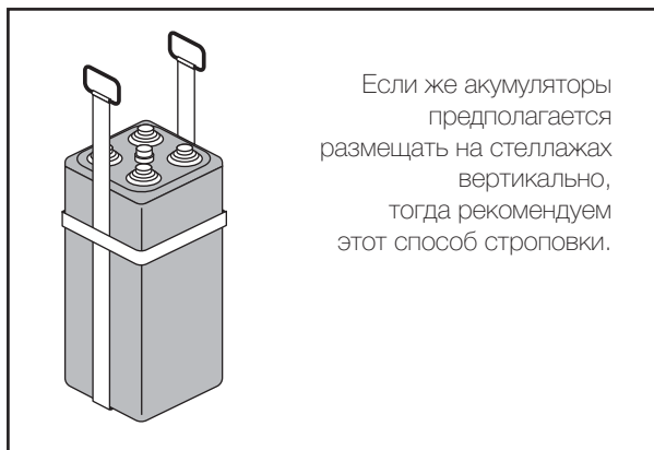
Рис. 9. Способ строповки аккумуляторов для вертикального перемещения.
